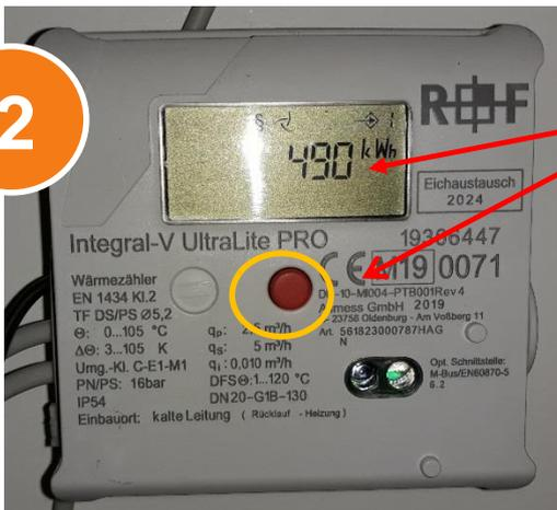
Durch **kurzes einmaliges Drücken** der roten Taste, wird das Display aktiviert und der aktuelle Zählerstand angezeigt.
